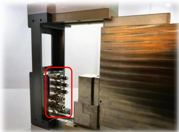
图3-1 微反应器插口示意图
