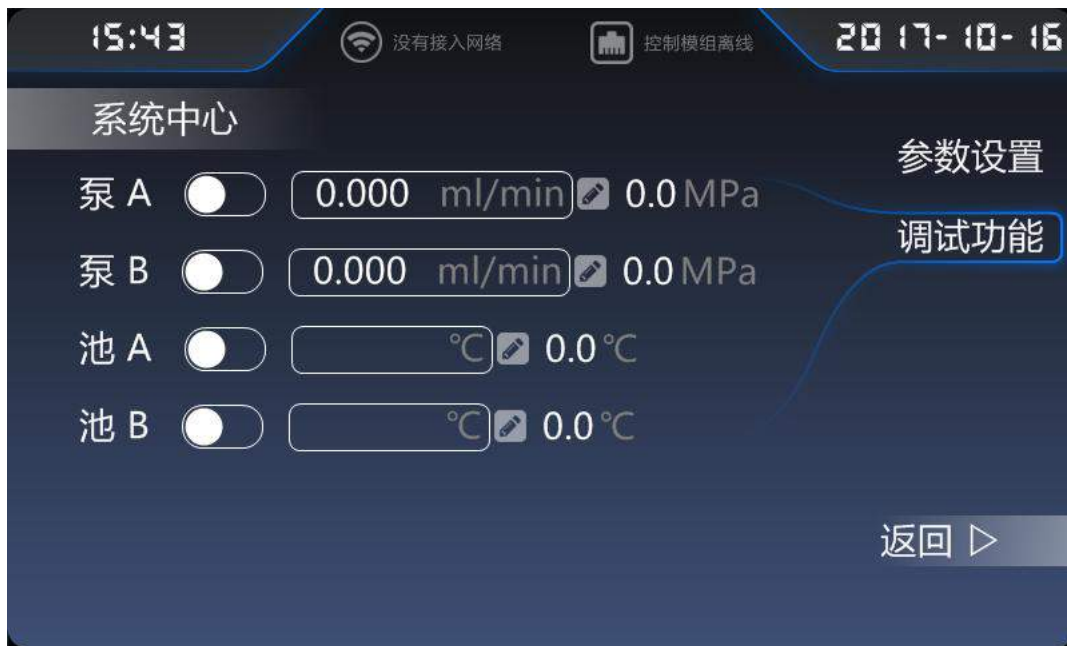
图 4-9 系统中心调试功能界面
